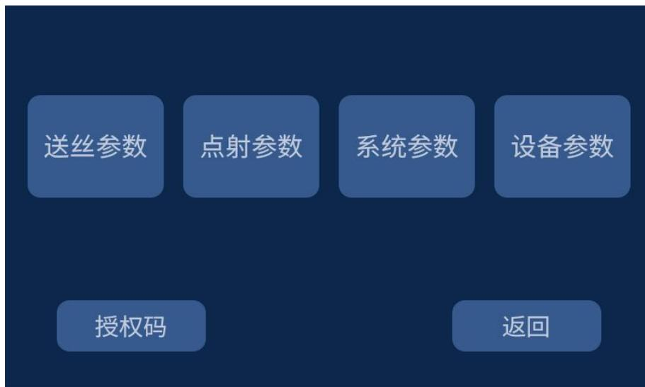
**7.2.2 工艺参数：** 用于设置焊接时激光控制、摆动类型和送丝等参数。
