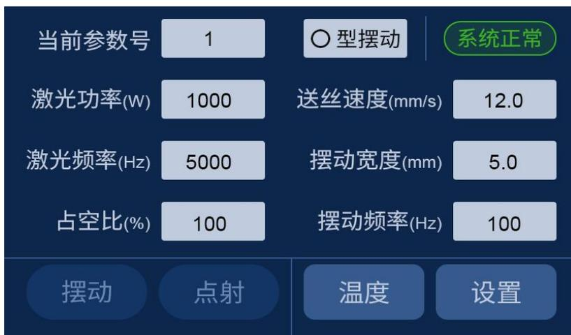
**【摆动】**：显示当前电机是否进行摆动。用户也可以通过此按钮控制振镜电机摆动开启或关闭。
